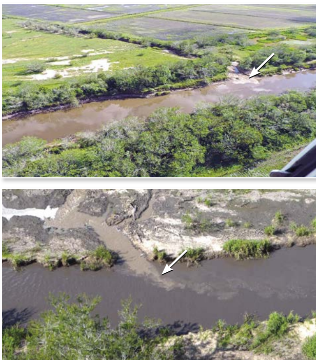
► Figura 7. Drenagens de duas lavouras de arroz irrigado: setas indicando aportes irregulares de sedimentos a um rio, com elevação da turbidez nas águas.
