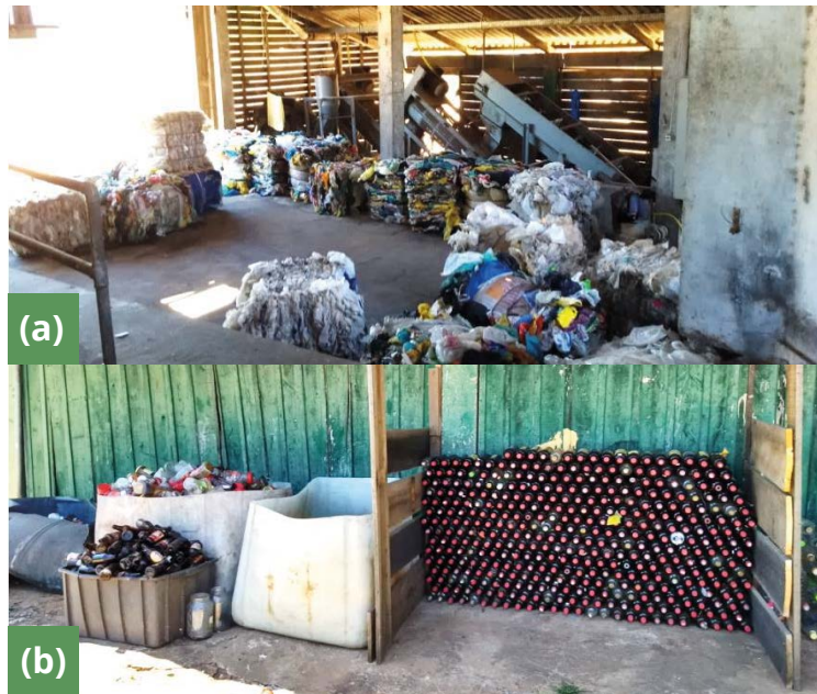
Figura 6. Central de triagem limpa e organizada. (a) Armazenamento de resíduos dispostos em local coberto. (b) Organização de garrafas de vidro.
