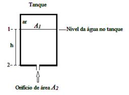
Assinale a expressão matemática que permite calcular corretamente a velocidade de escoamento da água através do referido orifício (velocidade de efluxo v<sub>2</sub>).
