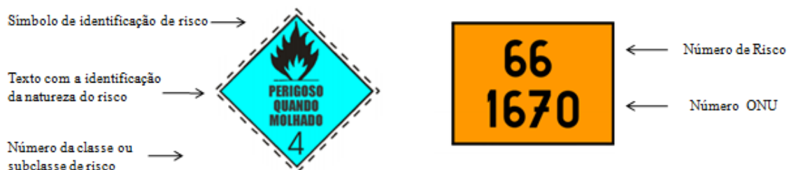
Figura 1 – Rótulo de Risco e Painel de Segurança
