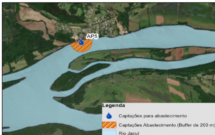
Figura 4.6 – Croqui do estabelecimento da área imprópria em ponto de captação.
