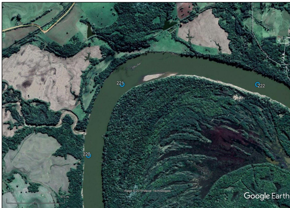
Figura 3.14 – Barra em pontal que ocorre no ponto 221, margem direita. Na margem esquerda ocorre processo erosivo, principalmente onde não há vegetação.
