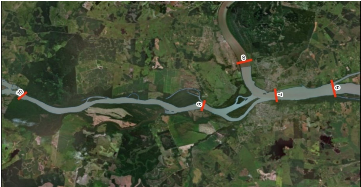
Figura 3.17 – As barras longitudinais começam a aumentar de montante para jusante, onde o tipo de canal fluvial sinuoso migra para canal entrelaçado. Fonte: Adaptado de Google Earth (2019).
