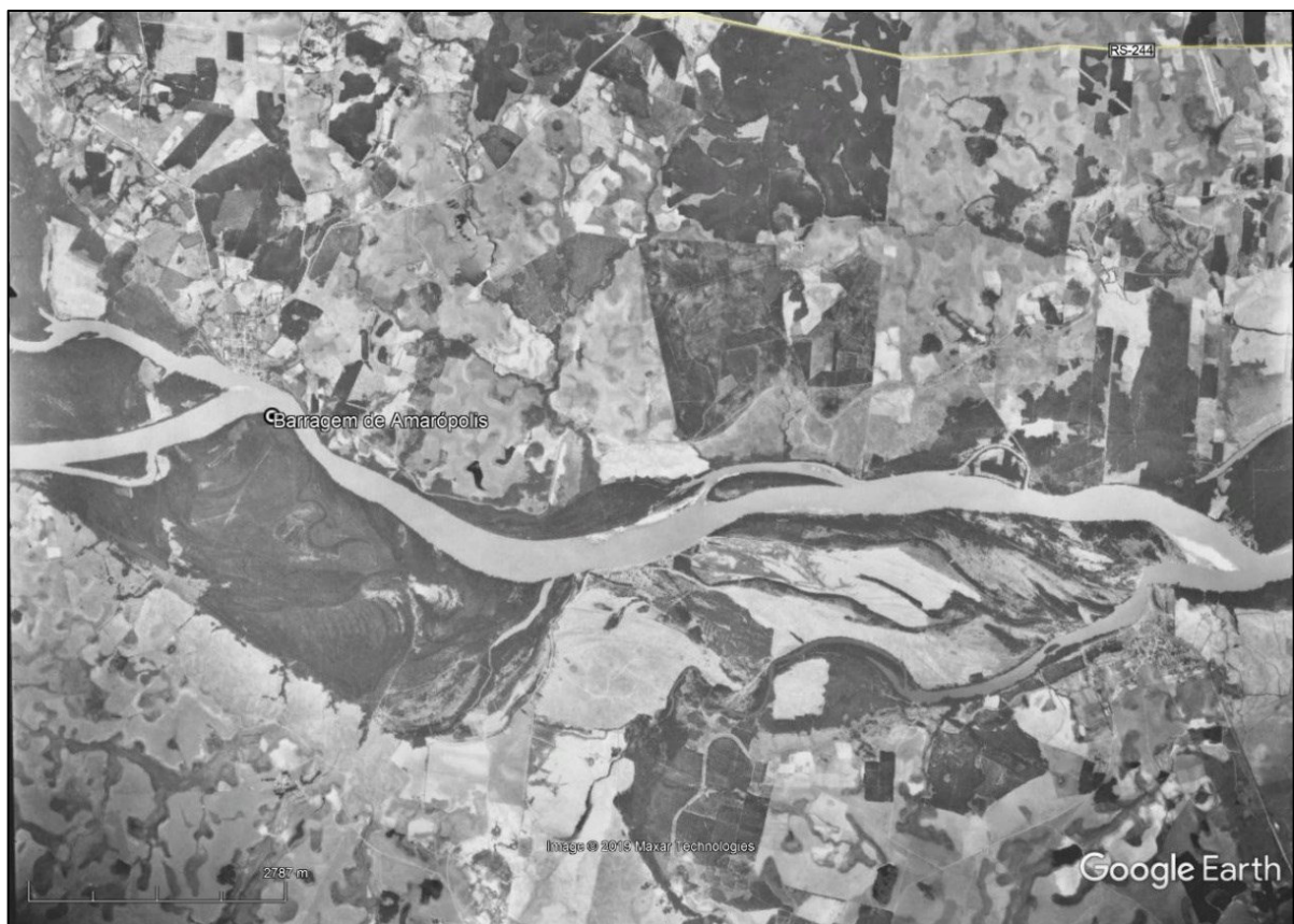
Figura 3.16 – Aerofoto nº 14576 (USAF/CPRM), de novembro de 1964, ainda sem a construção da Barragem de Amarópolis. Aqui se observa claramente que a jusante da barragem a calha maior possui as características típicas de um sistema meandrante.
