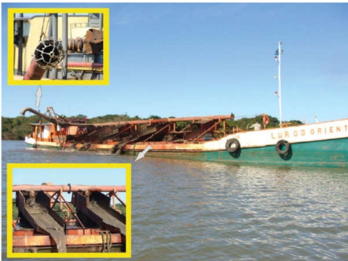
Figura 5.39 - Draga flutuante embarcada em ação no Baixo Jacuí. No detalhe, são observados a ponta de sucção da draga, e o sistema de peneiramento para retirada da fração cascalho da carga arenosa do leito do rio.
