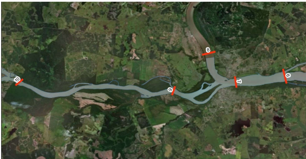
Figura 3.255 – As barras longitudinais começam a aumentar de montante para jusante, onde o tipo de canal fluvial sinuoso migra para canal entrelaçado como observado na Figura 3.256.
