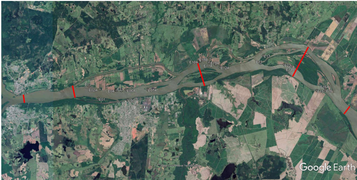
Figura 3.282 – Trecho a jusante do Rio Taquari onde se observa as seções de referência de sete (montante) até 3 (jusante) e os pontos de monitoramento das margens determinados pela DMIN/FEPAM para as empresas detentoras dos direitos minerários das áreas.
