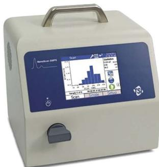
**Figura 5** – Nanoscan SMPS portátil, modelo 3910.
