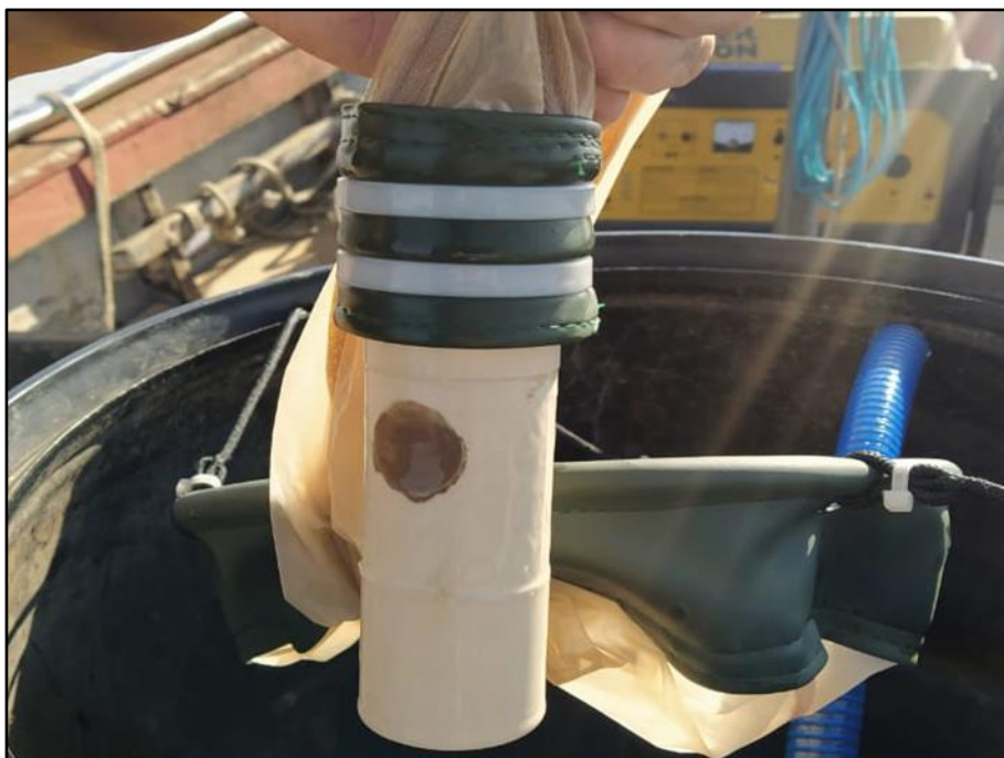
Foto 5: Copo coletor para amostras de zooplâncton.
