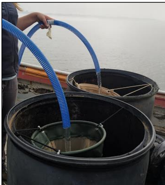
Foto 3: Amostra de fitoplâncton e zooplâncton, com bomba de sucção em rede de plâncton, coleta realizada no lago Guaíba/RS.
