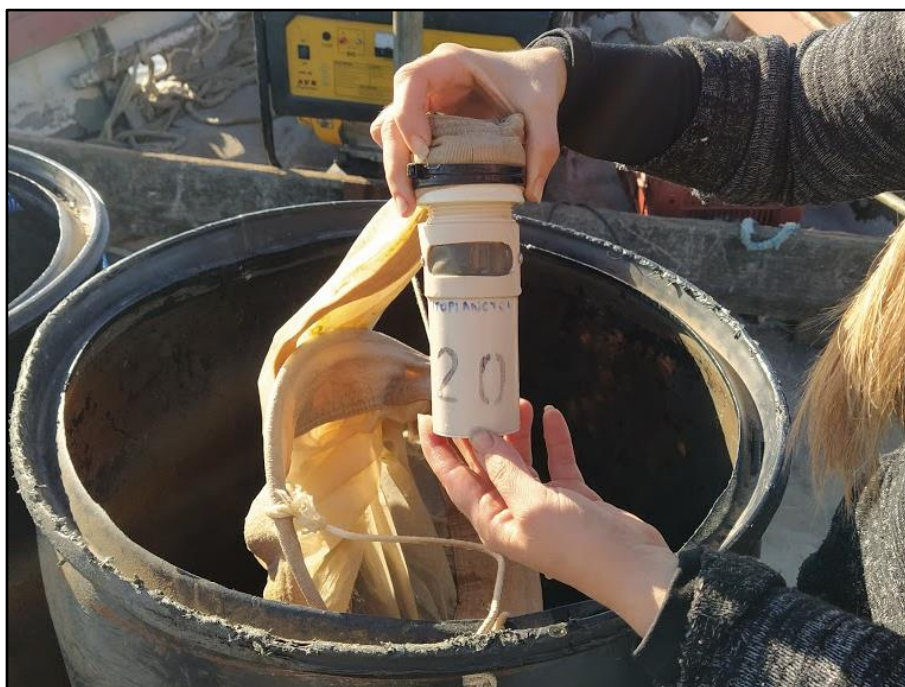
Foto 4: Copo coletor para amostras de fitoplâncton.
