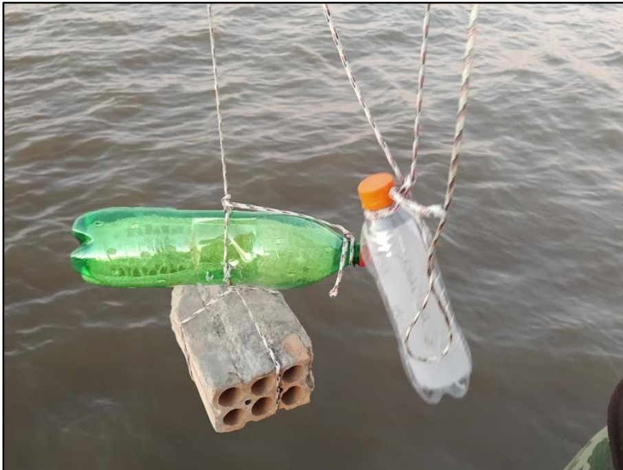
Foto 7: Substratos artificiais confeccionados com garrafas PET preenchidas com retículo celulósico da fruta bucha ( Luffa cylindrica ).
