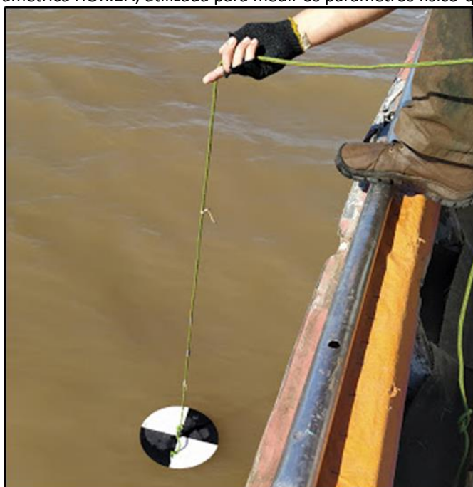
Foto 2: Disco de Secchi, utilizado para medir a transparência da água.
