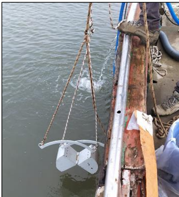
Foto 6: Amostrador draga tipo Van Veen, para coleta de macroinvertebrados no lago Guaíba/RS.
