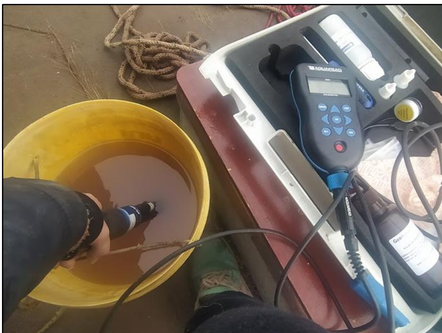
Foto 1: Sonda multiparamétrica HORIBA, utilizada para medir os parâmetros físico-químicos da água.
